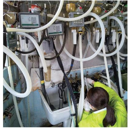
洗浄水槽内の水位や実際に出している洗剤量を計測します
