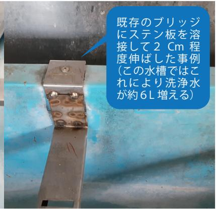
既存のブリッジを溶接して2cm伸ばした事例（この水槽ではこれにより洗浄水が増える）
