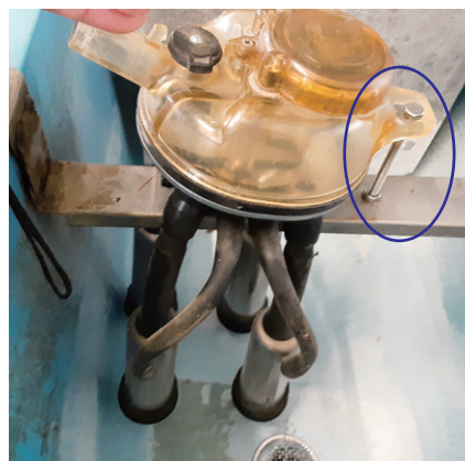
ブリッジを改良された例（ブリッジを下げ、ミルカーを引っ掛けられる棒を取り付けた）
